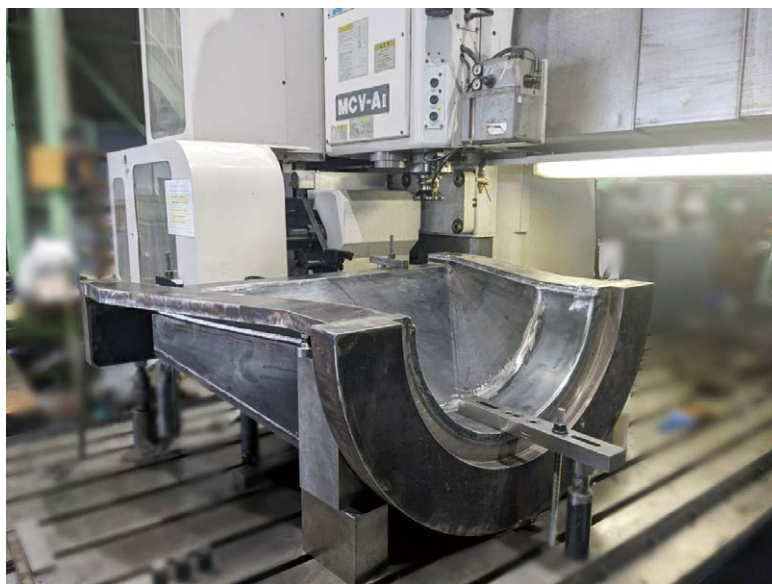
基準が取りにくい溶接構造・鋳物にも高い評価を得ている
