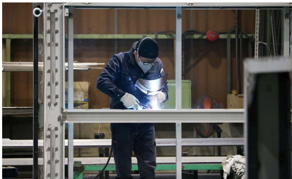
浄水場向けの屋外制御盤の溶接
