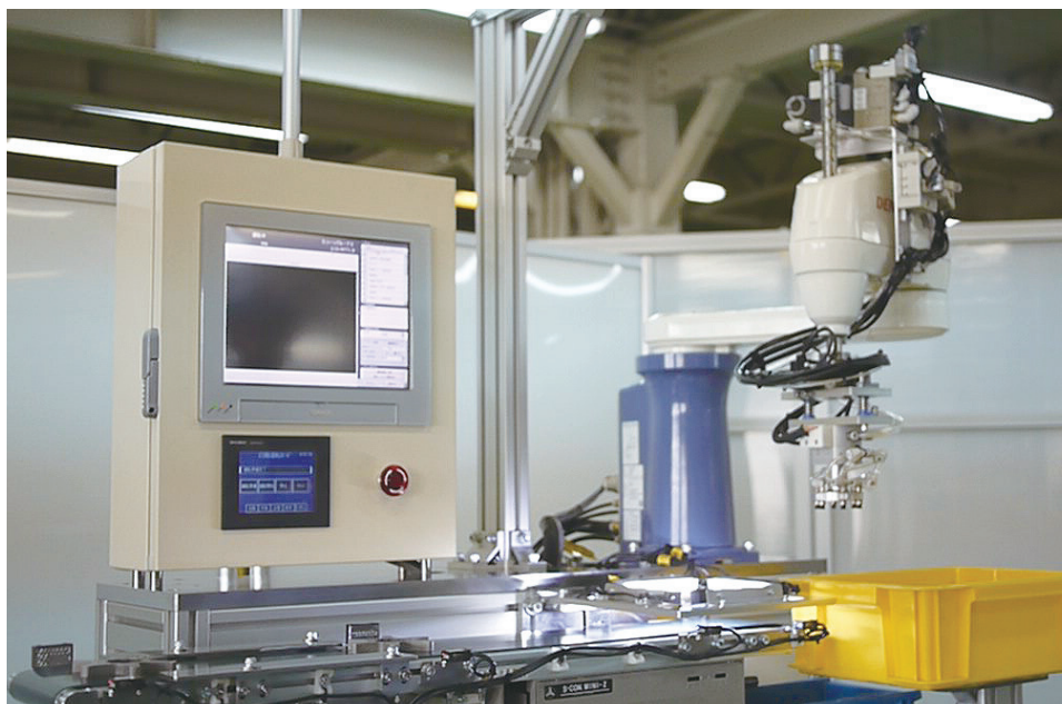
社内で手がけた多関節ロボットを活用した生産設備
