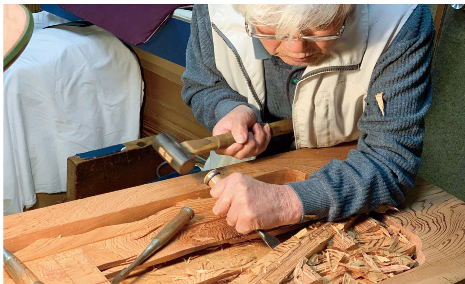
彫刻欄間を彫る
