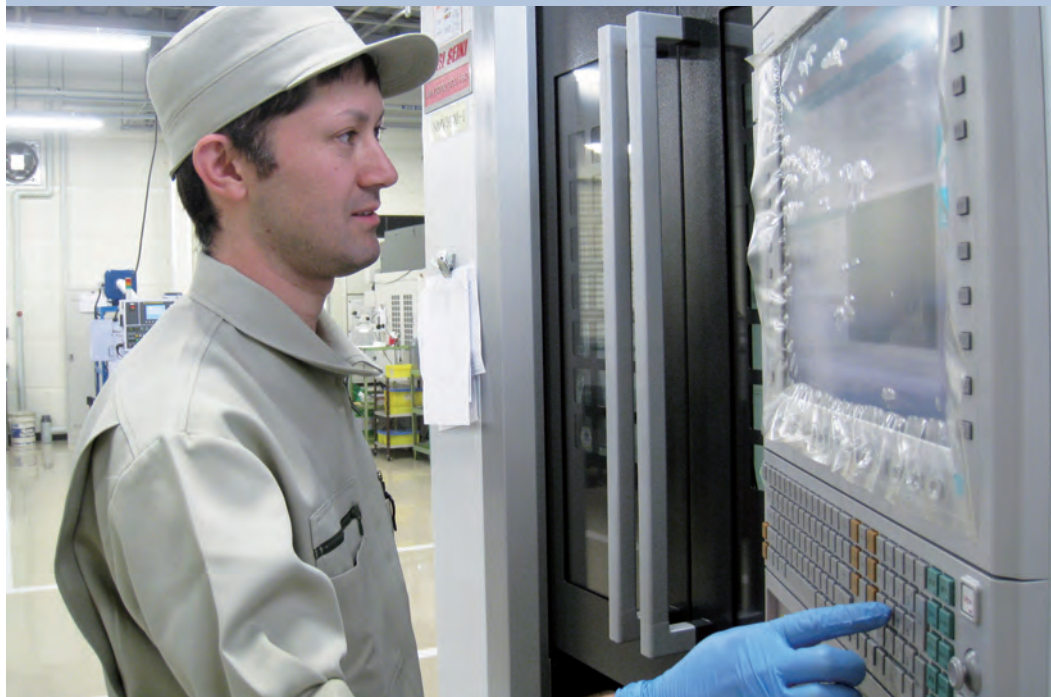
5軸マシニングセンターを操作して医療機器用部品を生産する
