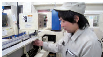
NC旋盤の材料供給機を調整
