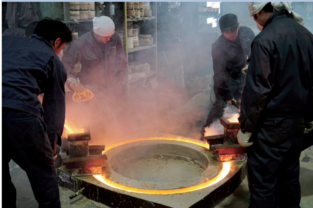
最高1,200℃に上る鑄込（いこ）みで大型リングを鑄造
