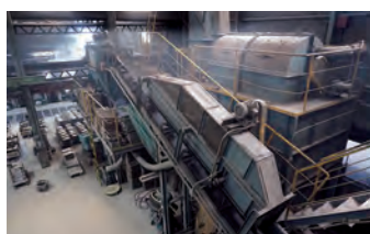
鑄型砂の自動処理装置で省人化
