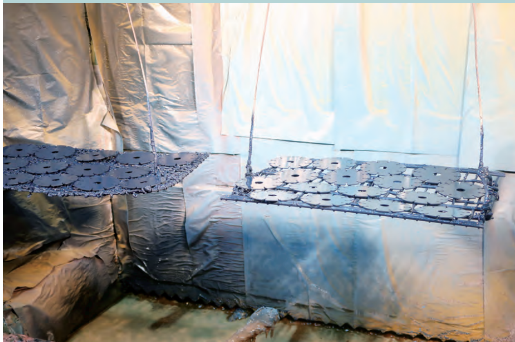
塗装ブースにセットされた製品
