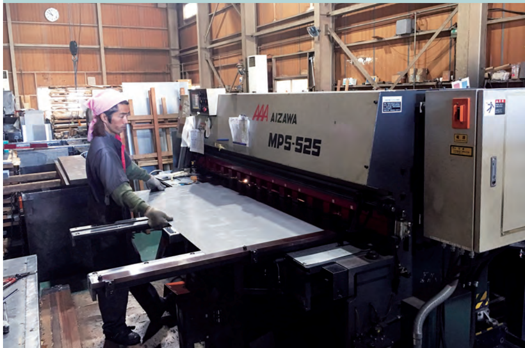
鉄板を高精度な鋼板に切断
