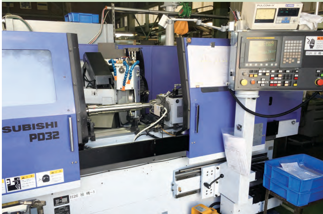
導入した研削盤は、端面、曲面(R)、軸が一度に研磨できる
