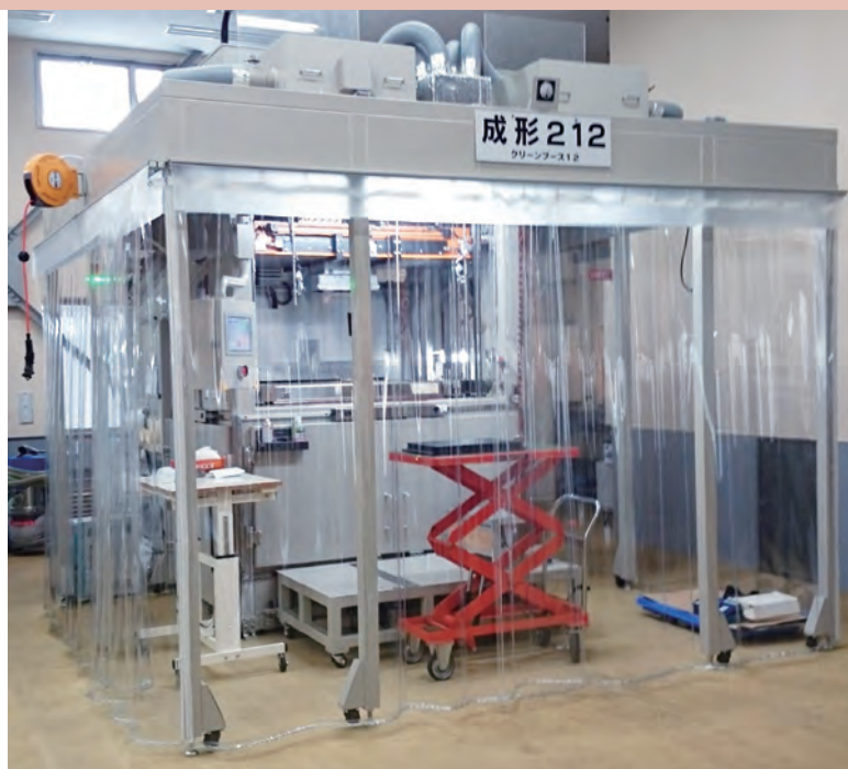
自社で開発したクリーン仕様の省エネ型圧空・真空成形機
