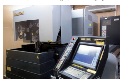
恒温室に設定したワイヤー加工機
