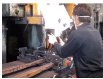
ワンタッチ着脱の金型交換
