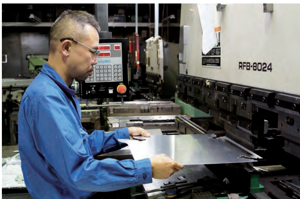
一般的に曲げ加工で使うプレスブレーキだが、豊里では多様な使い方をする
