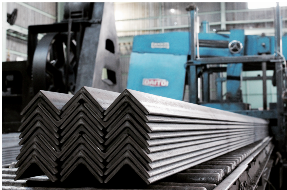
束ね切断する門型押さえバイスを搭載したバンドソー
