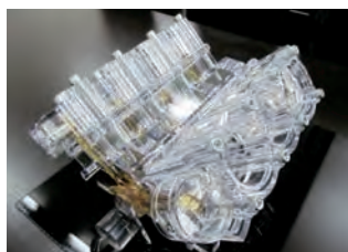
自動車用 V6 エンジンの透明モデル (ポリカーボネード製)
