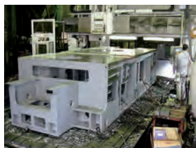
機械フレームの製缶・機械加工
