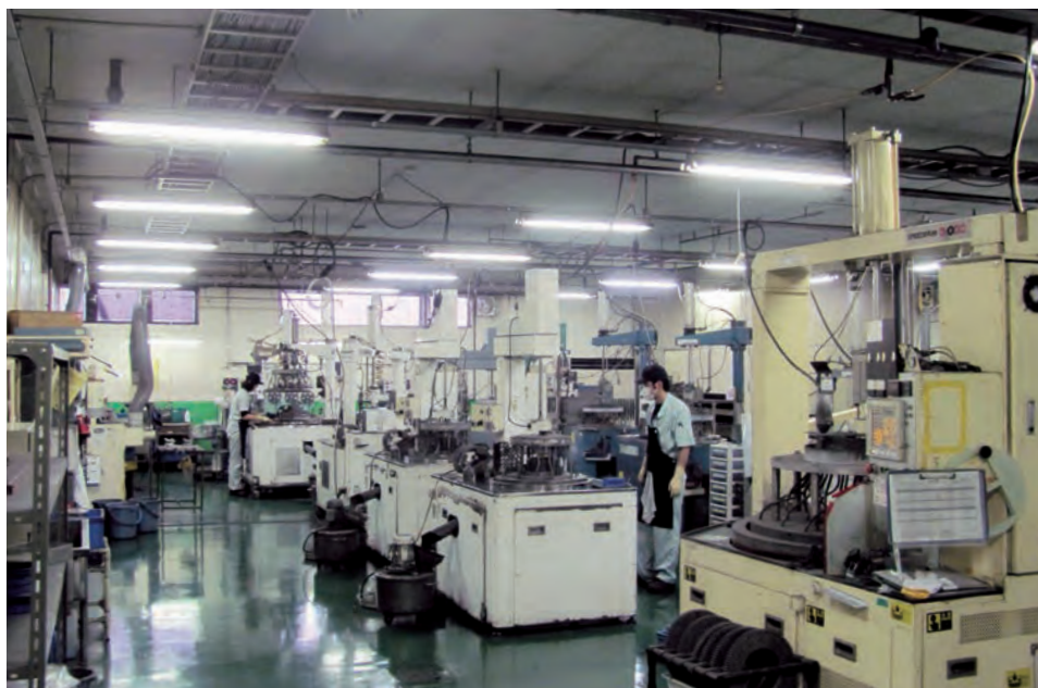
落合事業部工場内のポリシング加工の様子
