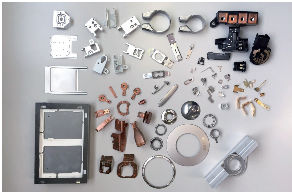
金属プレス技術を駆使し成形された各種部品
