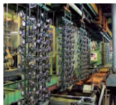
本社工場のめっきライン
