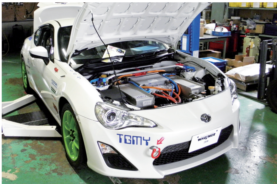
減速機を搭載し効率的な走りを実証した電気自動車「トヨタ86」
