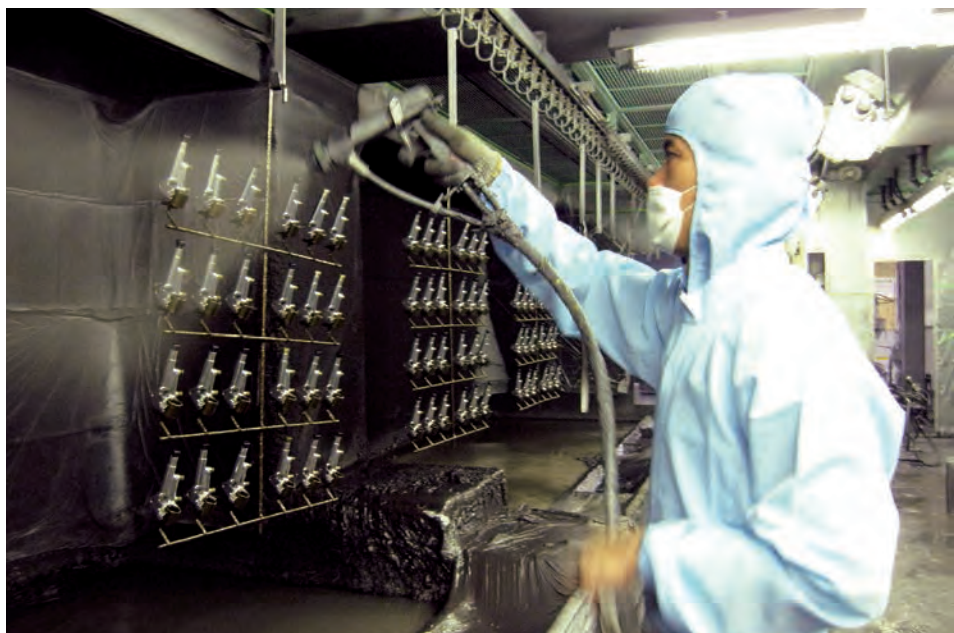
職人技による吹付塗装
