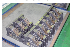
独自のカム機構を備えた金型部品
