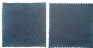
「クインセッター P-100D」のポリエステルフリース布ピリングテスト結果。未処理（左）、処理（右）
