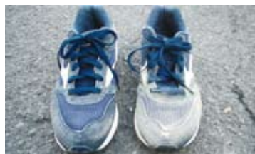
サッカーの試合後、軽くはいた未加工靴(右)と加工靴(左)
