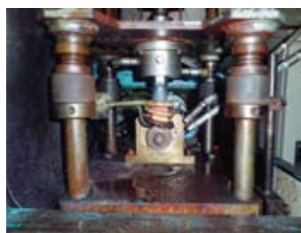
熱間加工潤滑剤開発に使う試験機
