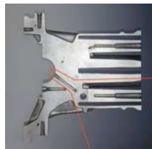
冷却効果（赤線内）できれいに仕上がられたシリンダー断面
