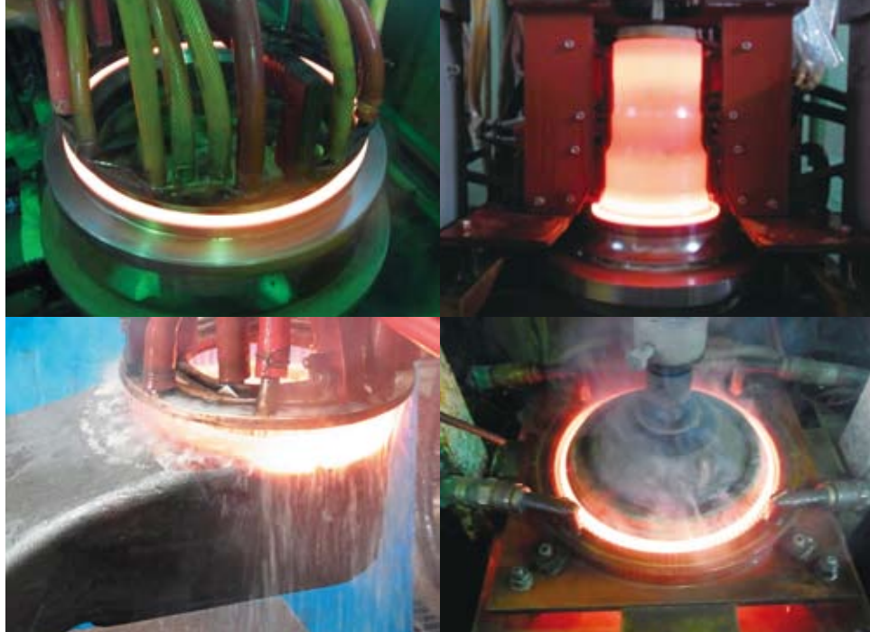
加熱作業の様子。部品に高熱を加えた後、急冷することで強度を高める
